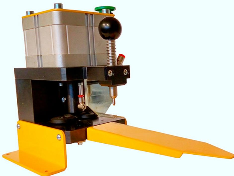
Macchina di foratura per profili vetrocamera con gas che serve a creare il foro diametro 5 mm simultaneamente su entrambi i lati del profilo.
